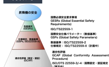
例 昇降機安全設計の基本的考え方
